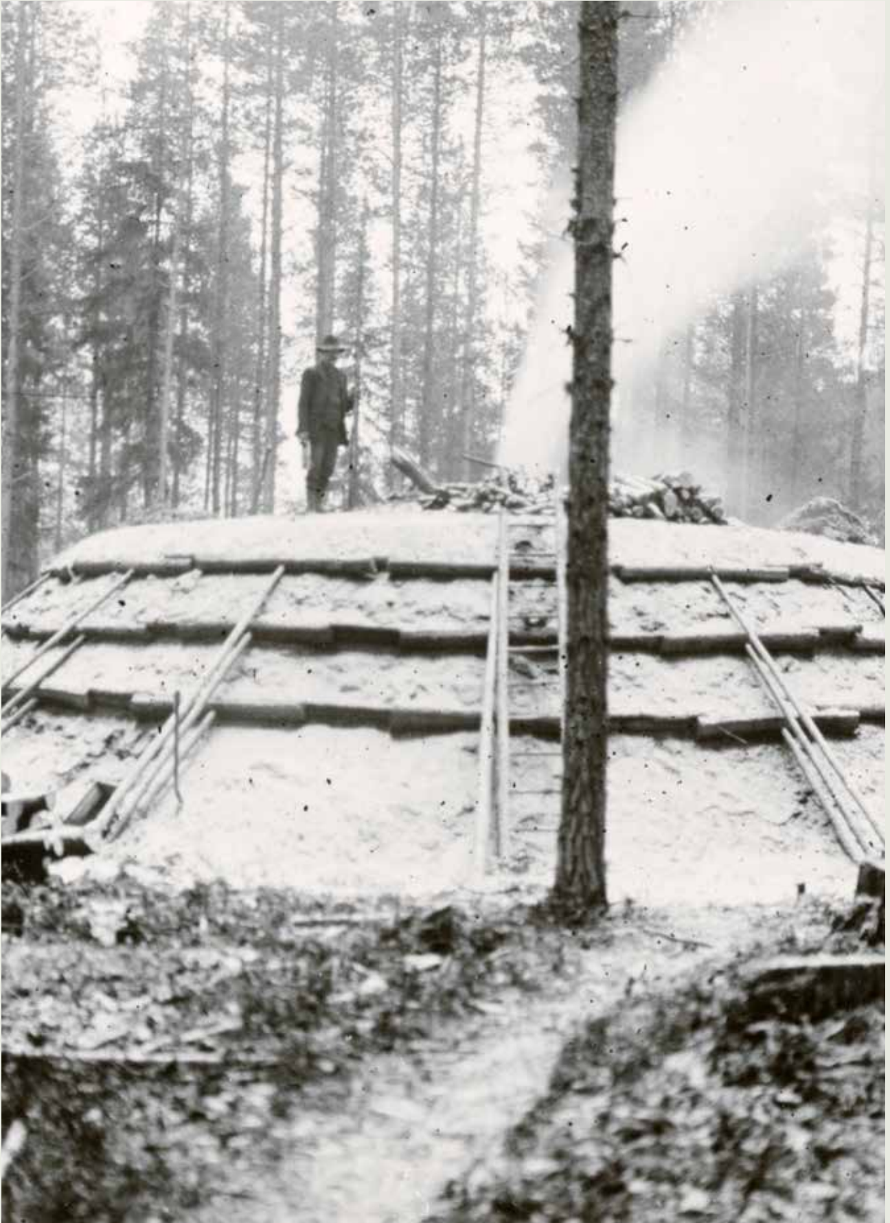
En kolmila som nyss har tänts. Det tog ungefär tre veckor innan kolningsprocessen var färdig och under tiden krävdes ständig passning.
