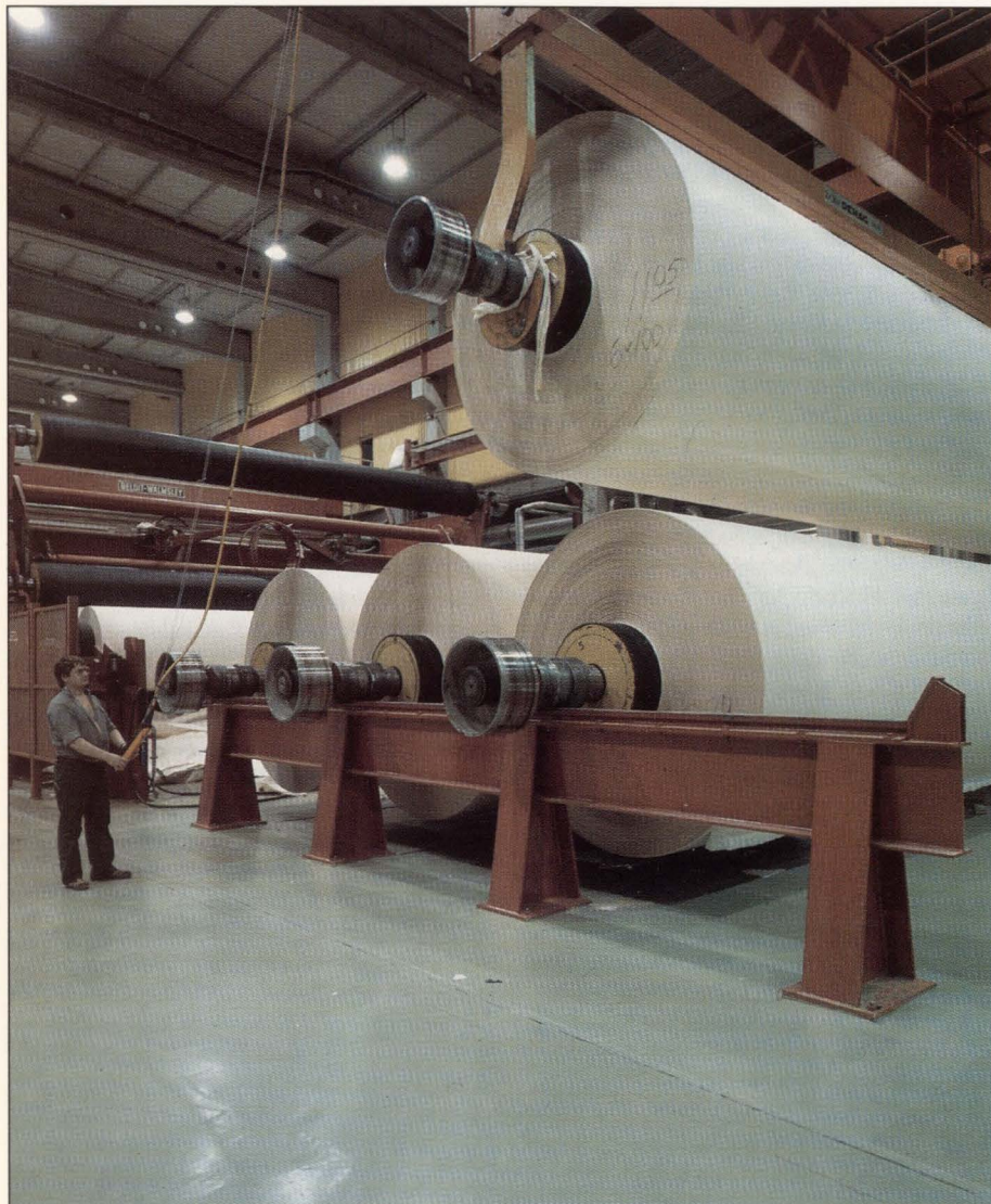
Uppkörningen av den nya pappersmaskinen i Örtviken, som togs i drift i slutet av 1985, har under året förlöpt mycket tillfredsställande. Medeldygnsproduktionen ligger mellan 550-600 ton, vilket innebär att kapaciteten nått i närheten av projekterade 210.000 ton per år.
