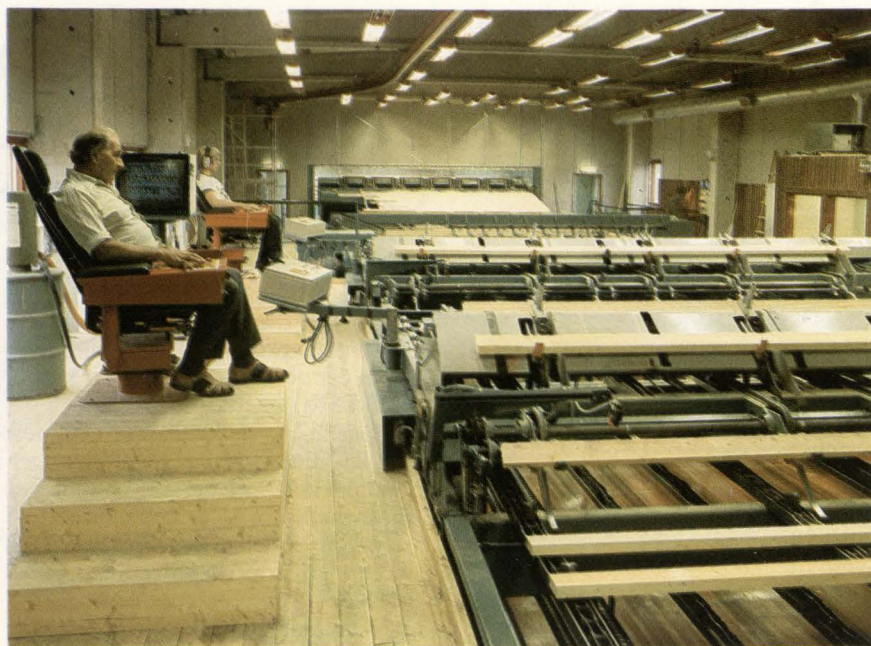
Lugnviks sågverk övergick till tvåskiftsdrift under 1982 efter ett investeringsprogram omfattande bla fastbränslepanna, utökad torkkapacitet samt ett nytt justerverk – bilden.
