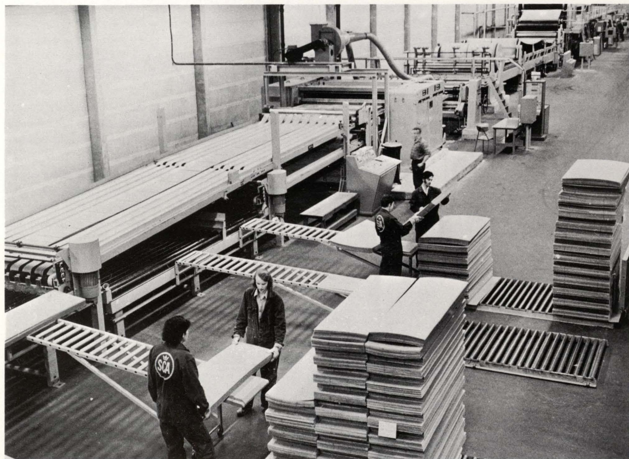
Wellpappmaskin vid SCA Emballage AB:s fabrik i Järfälla utanför Stockholm.
