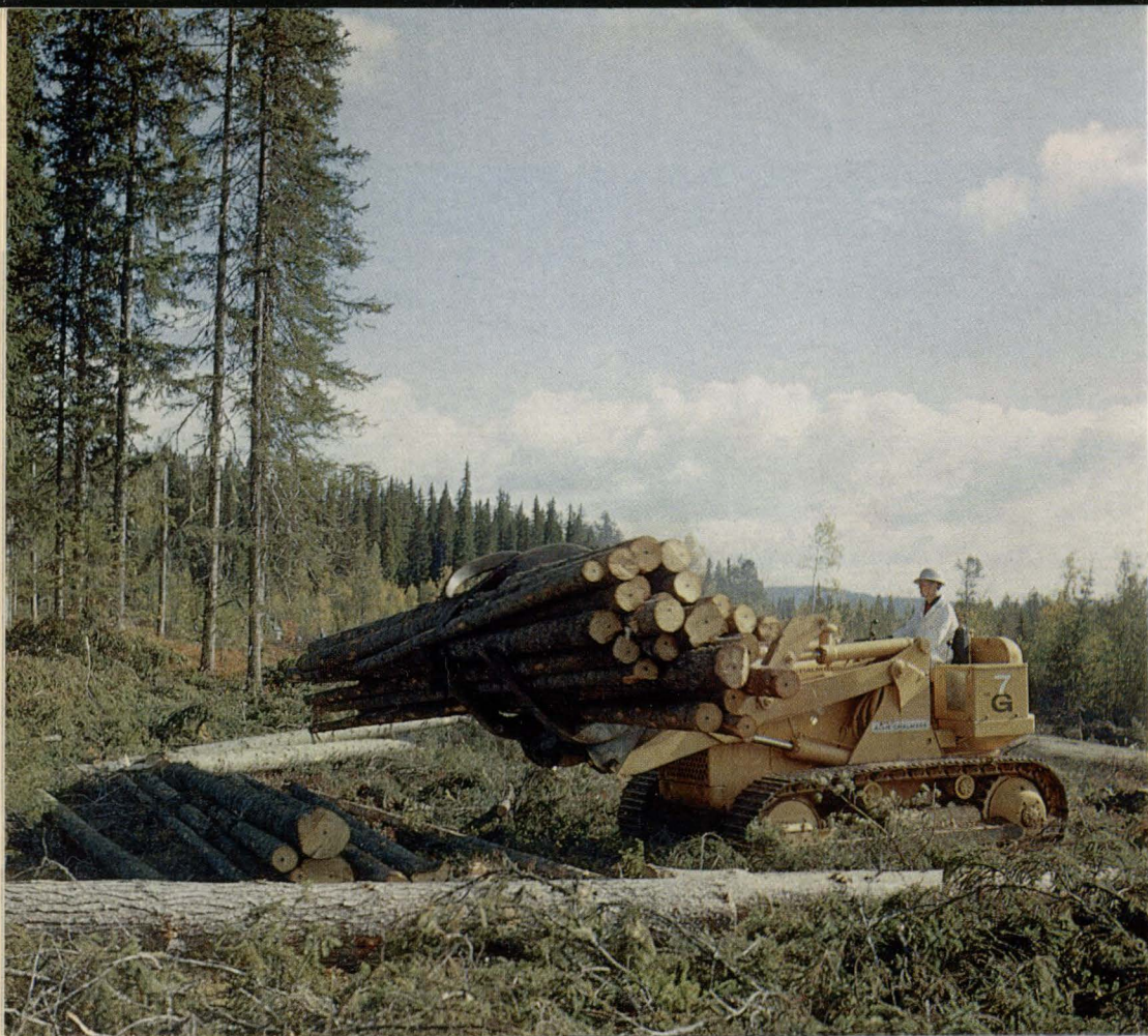
Terrängtransport på bar- mark med gaffelutrustad bandtraktor.
