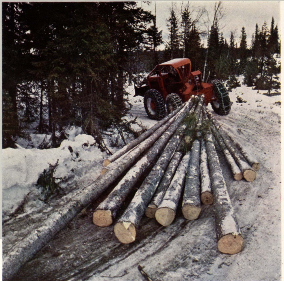
Transport till skogsbilväg av stamlängder med ter- ränggående specialtraktor.
